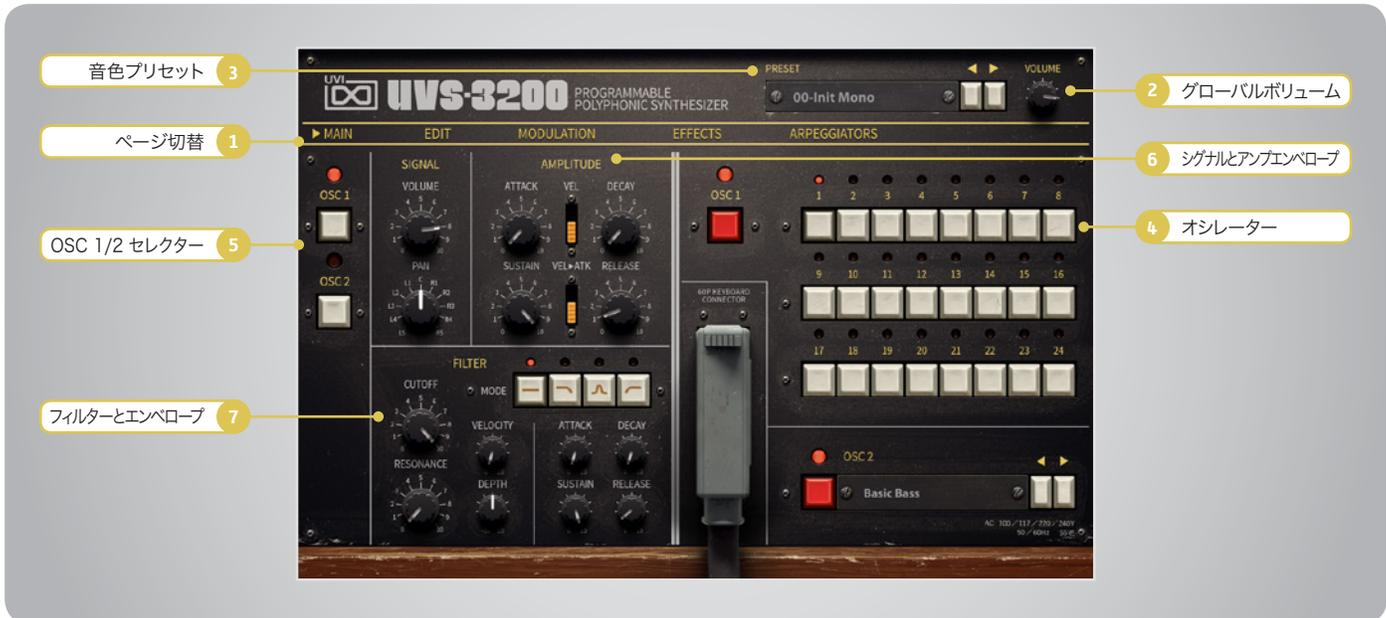
UVS-3200は2つのオシレーター:OSC 1と2で構成されています。OSC 1は24プリセット波形、OSC 2はOSC 1のプリセット波形を含む合計69のプリセット波形が用意されています。それぞれのオシレーターに専用のボリューム、パン、フィルターとエンベロープ、アルペジエーター(別ページ:ARPEGGIATORS)が用意されています。そして別ページでアクセスできるエディット(EDIT)とエフェクト(EFFECTS)は2つのオシレーターの信号ミックスを扱い、モジュレーション(MODULATION)はOSC 1と2、あるいはその両方をパラメーターごとにターゲットアサインが可能です。
