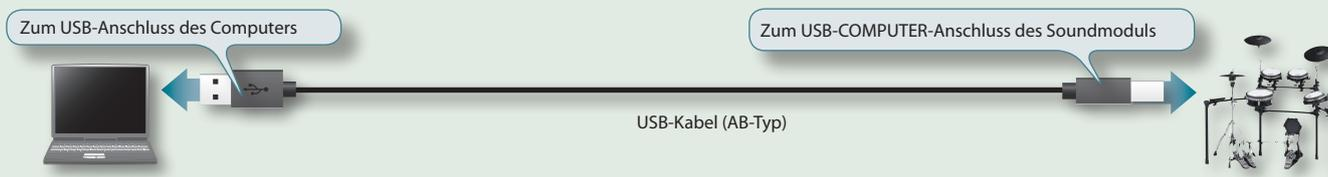
**\* Wenn Ihr V-Drums-Modul nicht über USB-Audio-Funktionalität verfügt, verbinden Sie den „Audio-Ausgang“ des Computers mit einem Audiokabel mit der „MIX IN-Buchse“ des V-Drums-Sound-Moduls.**
