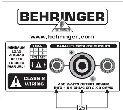
Fig. 2.5: Parte posterior del BX4500H (Detalle 2)
