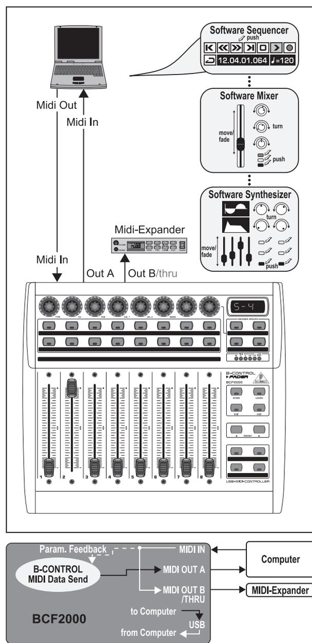
Fig. 4.9: Applicazione e routing nel modo Stand Alone 4
