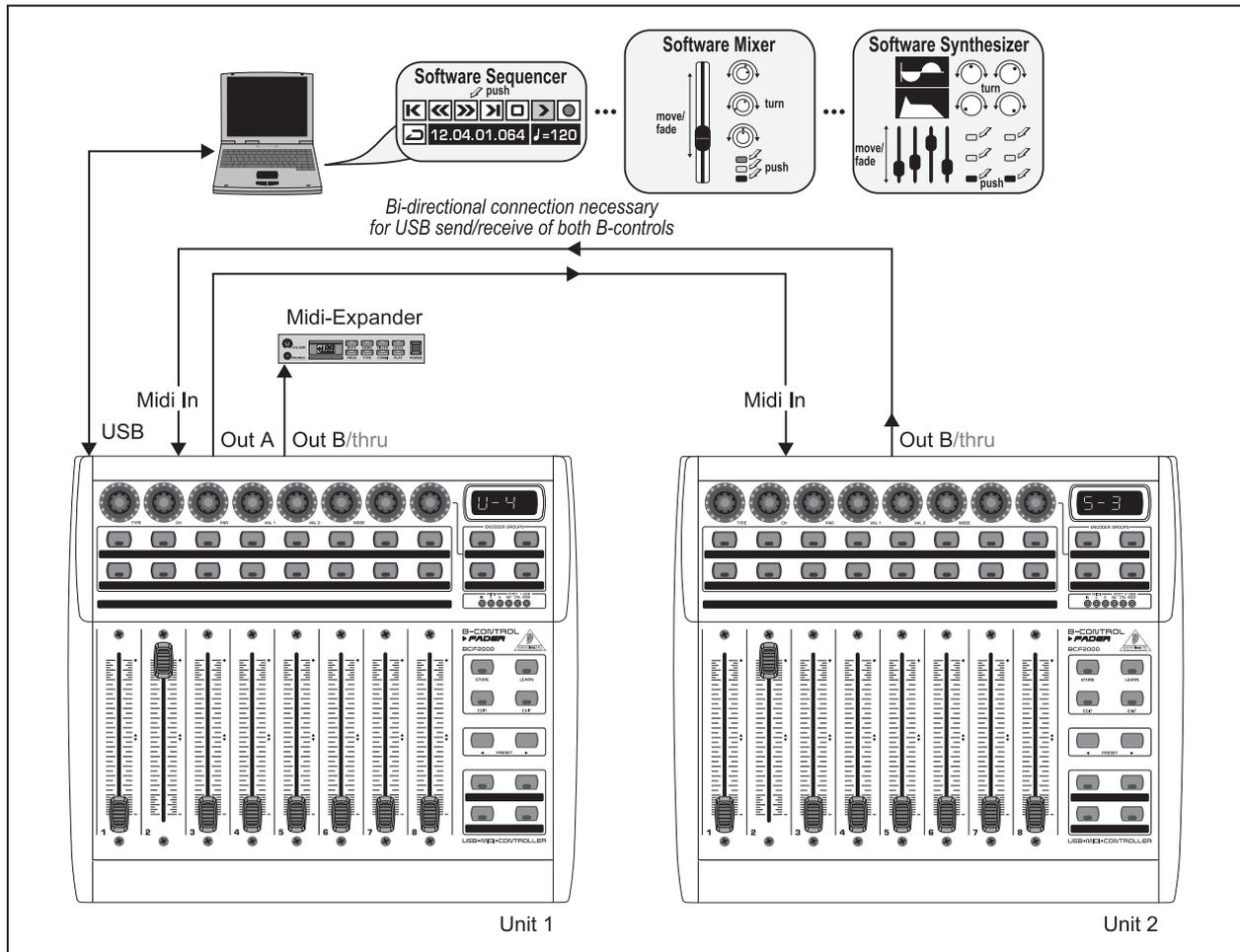
Fig. 4.4: Applicazione nel modo USB 4 (Expanded)
