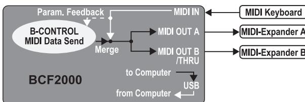
Fig. 4.6: Routing e applicazione nel modo Stand Alone 1
