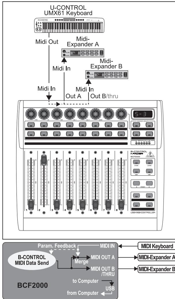
Fig. 4.8: Applicazione e routing nel modo Stand Alone 3
