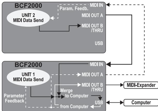
Fig. 4.5: Routing nel modo USB 4
