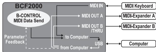
Fig. 4.3: Routing e applicazione nel modo USB 3
