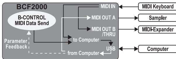
Fig. 4.2: Routing e applicazione nel modo USB 2
