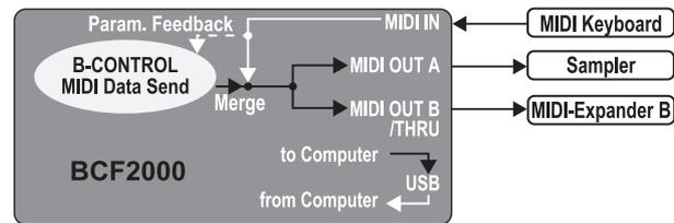
Fig. 4.7: Routing e applicazione nel modo Stand Alone 2
