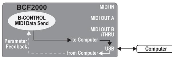
Fig. 4.1: Routing e applicazione nel modo USB 1
