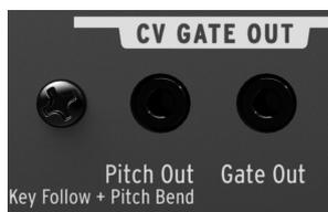
MiniBrute から他のアナログデバイスをコントロールできます。Pitch Out 1/4" ジャックは、MiniBrute のキーボードやピッチホイールを使って生成された CV 信号を CV GATE OUT 1/4" 端子から外部デバイスに送信できます。
