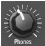
ヘッドフォン “**Phones**” ノブは、リアパネルにあるヘッドフォン出力端子の音量レベルを設定します [4.3.3]。ヘッドフォンを使用する際は、音量レベルに注意してください。
