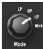
4種類のフィルターモードから選択します：LP (ローパス), BP (バンドパス), HP (ハイパス), そして Notch (ノッチ) です。LP モードは最も一般的に使用されているモードで、マイルドでファットなサウンドを生み出します。BP および HP モードは薄っぺらでギスギスしたサウンドになります。LFO を併用すると、Notch フィルターモードでは、フェイザー効果に似たサウンドを作ることが可能です。
