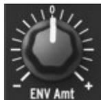
エンベロープアマウント “ENV Amt” は、フィルターのカットオフ周波数を変調する意図で送られるエンベロープ信号の極性と適用量を設定します。“0” 位置（12時の位置）ではエンベロープ変調は無効になります。ノブを反時計回り方向（0より小さい値）に回すと、ENV Amt ノブは反転した ADSR エンベロープを適用、送信し始めます。
