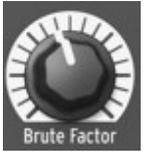
**Brute Factor** は MiniBrute 特有の機能で、有名なビンテージモノシンセサイザーが搭載していたパッチを再現したものです。このシンセサイザーは、ヘッドフォン出力端子をオーディオ入力端子に接続して、フィードバックループエフェクトを生み出し、エッジの効いたグランジサウンドを作り出すことができたのです。このパッチは、内部結線した形で MiniBrute 上で再現、**Brute Factor** ノブで制御できるようになったのです。このノブのデフォルトポジションは、反時計回り方向に振り切った位置です。この状態では **Brute Factor** は無効になっています。ノブを回すにつれ、出音にディストーションが加えられます。**Brute Factor** 設定値が低い状態では、マイルドでスムーズなディストーション、ノブを回していくと、出音はエッジの効いたディストーションに変化していきます。ノブの位置が 75% 以上のポジションでは、制御が効かないくらいフィードバックサウンドが顕著になり、荒々しい音に変貌します。
