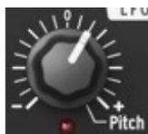
ピッチ “Pitch” ノブは、LFO 信号のピッチ、および適用量を調整します。“0” 位置 (12 時の位置) では、ターゲットに対してモジュレーション信号は送られません。反時計方向に回すと (“0” 位置より下)、**Pitch** ノブは、反転した LFO 信号を送信し始めます。時計回り方向に回すと (“0” 位置より上)、**Pitch** ノブは、ノーマルな LFO 信号を送信し始めます。
