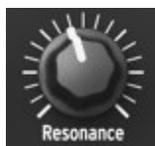
カットオフ周波数のレゾナンスピークを設定します。時計回りに回すと、カットオフ周波数周辺の部分音を強調し、よりアグレッシブなサウンドに変化します。ノブを回して、設定レンジの 75% より上の位置に設定すると、フィルター自体が発振するようになりますが、その動作は設定されたカットオフ周波数に依存します；MiniBrute のフィルターは、350 Hz から 8 kHz のレンジで自己発振するようにデザインされています。自己発振レンジを広げるには、Brute Factor ノブ [4.2.8.4] を使います。
