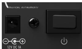
AC 電源コネクタに電源用のコードを差し込み、電源を MiniBrute に供給します。同梱の電源コードをご使用下さい：電源の仕様 12VDC, 1A, センタープラス (+)。
