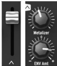
三角波とメタライザーのレベルは、三角波のアイコンが付されたスライダを使って設定します。スライダを下方向いっぱい下げると、信号を完全にミュートします。反対にスライダを上げていくとレベルが上昇します。**Metalizer** ノブを反時計回り方向に振り切った位置から時計回り方向に回していくと、三角波特有の耳障りのよいフルートのようなサウンドから複雑でメタリックなサウンドに変化していきます。
