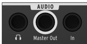
マスター出力 “Master Out” を、オーディオアンプ、ミキサー、パソコンのサウンドカード等にアンバランスケーブルで接続します。Master Volume [4.2.8.6] ノブを使って、全体的な出力レベルを調整します。
