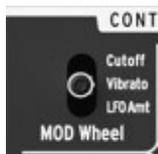
モジュレーションホイール “MOD Wheel” スイッチを使って、モジュレーションホイールの割り当てを設定します [4.2.8.2]。スイッチの設定位置により、モジュレーションホイールの挙動が切り替わります；フィルターカットオフ周波数（**Cutoff** 位置）、オシレーターに送られるビブラート適用量（**Vibrato** 位置）、LFO 信号を種々のターゲット（**PWM & Metalizer**、**Pitch**、**Filter**、**Amp**）に適用する量（**LFO Amt** 位置）の3つです。三つめのオプション（**LFO Amt**）では、LFO モジュレーション信号はすべてモジュレーションホイールによって制御されます。最小設定位置では（**Min**）、ターゲットは LFO 信号をまったく受け取らないことになりません。従ってスイッチがこの位置にセットされている場合は、モジュレーションホイールが最大設定位置にあることを確信してください。
