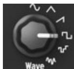
LFO 用のモジュレーション波形として数種類用意されています。この中からウェーブ (Wave) ノブを使って選択します：サイン波、三角波、ノコギリ波、矩形波、ランダムステップ波（別名：Sample & Hold）、ランダムグライド波から選択可能です。
