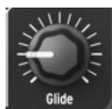
グライド “Glide” ノブは、ポルタメント（キーボード上、あるいはアルペジエーターの任意の音階から他の音階に滑るように上昇/下降するのにかかる時間のこと）の適用量を設定します。ノブを反時計回り方向に振り切ると、グライドは適用されず、任意の音階から次の音階へは即座に移行します。ノブを時計回り方向に振り切ると、ポルタメント効果が最大になります。最大設定では、MiniBrute キーボードの一番低い C 音から一番高い C 音に移行するまで（2オクターブ）に、約 4 秒かかることとなります。
