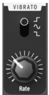
ビブラート “Vibrato” とは、オシレーターピッチモジュレーション専用の低周波オシレーター（LFO）を意味します。これは他のモジュレーションソースからは完全に独立しており、モジュレーションの深さとトリガーはモジュレーションホイール [4.2.4.1] とアフタータッチスイッチ [4.2.4.2] からコントロールできます。ここでは、3ポジションスイッチを使って、3種類の異なるモジュレーション波形から選択できます：
