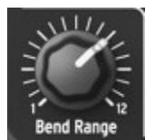
ベンドレンジ “Bend Range” ノブは、ピッチホイール [4.2.8.2] レンジを設定します。ノブを反時計回り方向に振り切ると、ピッチホイールレンジは  $- \frac{1}{2}$  音階（最小位置）から  $+ \frac{1}{2}$  音階（最大位置）で可変します。ノブを時計回り方向に振り切ると、ピッチホイールレンジは  $- 1$  オクターブ（最小位置）から  $+ 1$  オクターブ（最大位置）で可変します。
