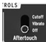
アフタータッチ “Aftertouch” スイッチは、アフタータッチ信号の割り当てを切り替えます；アフタータッチは演奏中に他のノブやスライダを操作することなく、モジュレーション信号をトリガーできるため、サウンドに表情を加える場合には、とても便利な機能です。アフタータッチ “Aftertouch” スイッチには3通りの設定が考えられます：フィルターカットオフ周波数にルーティングする場合（Cutoff）、ビブラートをトリガーする場合（Vibrato [4.2.5]）、無効にする場合（Off）です。
