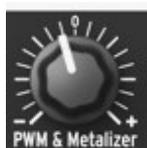
**PWM & Metalizer** ノブは、LFO 信号の極性、および適用量を調整します。この LFO は、パルス波オシレーターのパルス幅、およびメタライザーのフォールドレベルを変調します。“0” 位置 (12 時の位置) では、ターゲットに対してモジュレーション信号は送られません。反時計方向に回すと (“0” 位置より下)、**PWM & Metalizer** ノブは、反転した LFO 信号を送信し始めます。時計回り方向に回すと (“0” 位置より上)、**PWM & Metalizer** ノブは、ノーマルな LFO 信号を送信し始めます。
