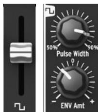
一般的な矩形波、およびパルス幅変調信号のレベルは、矩形波のアイコンが付されたスライダを使って設定します。スライダを下方向いっぱい下げると、信号を完全にミュートします。反対にスライダを上げていくとレベルが上昇します。ENV Amt（エンベロープアマウント）ノブを12時位置（“0”位置）に設定し、さらに Pulse Width ノブを反時計回り方向に振り切った位置（“50%”位置）に設定すると、矩形波のみ聞こえるようになります。Pulse Width ノブを時計回り方向に振り切ると、矩形波は非対称のパルス波に変化し、Pulse Width を 90% まで増加させ、アシッドサウンド
