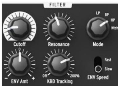
4種類のレスポンスモード（前述、LP, BP, HP, Notch）を備えたフィルターを使って、オシレーターの音色を変化させることができます。カットオフ、およびレゾナンスはマニュアル操作で調整が可能です。カットオフはキーボードから制御することが可能で、その他にも様々なモジュレーションジェネレーターから変調を加えることが可能です。MiniBrute に搭載されたフィルターは、Nyle Steiner 氏が 1970 年代に開発した Sallen & Key 型を採用しており（70年代に開発されたデザイン）、 $-12$  dB/Oct スロープの LP, HP フィルターモード、さらに  $-6$  dB/Oct スロープの BP, Notch フィルターモードを実現しています。
