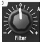
フィルター “Filter” ノブは、LFO 信号の極性、および適用量を調整します。この LFO はフィルターのカットオフ周波数を変調します。“0” 位置（12 時の位置）では、ターゲットに対してモジュレーション信号は送られません。反時計方向に回すと（“0” 位置より下）、Filter ノブは、反転した LFO 信号を送信し始めます。時計回り方向に回すと（“0” 位置より上）、Filter ノブは、ノーマルな LFO 信号を送信し始めます。
