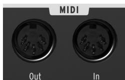
**MIDI Out / In** ジャックを介して、お手持ちの MiniBrute を他の MIDI デバイスに接続できます。MiniBrute は、外部デバイスのポリフォニック MIDI コントローラー、MIDI 音源モジュールとして使用できます。MiniBrute を音源モジュールとして使用する場合、MiniBrute の **MIDI In** を他の MIDI デバイスの MIDI Out コネクタに接続します。MiniBrute のキーボードから他の MIDI デバイスをコントロールする場合、MiniBrute の **MIDI Out** コネクタから他の MIDI デバイスの MIDI In コネクタに接続します。
