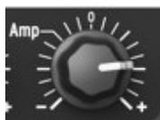
アンプ “Amp” ノブは、LFO 信号の極性、および適用量を調整します。この LFO はアンプレベルを変調します。“0” 位置（12 時の位置）では、ターゲットに対してモジュレーション信号は送られません。反時計方向に回すと（“0” 位置より下）、Amp ノブは、反転した LFO 信号を送信し始めます。時計回り方向に回すと（“0” 位置より上）、Amp ノブは、ノーマルな LFO 信号を送信し始めます。
