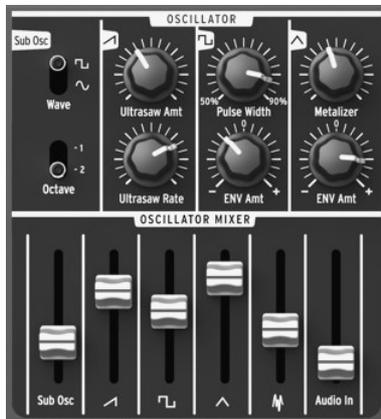
オシレーターは基本的な3種類の波形を生成します：ノコギリ波、パルス波、三角波の3つです。これらの波形はシグナルミキサーからアクセスでき、それぞれのレベルはスライダを使って調整できます。サブオシレーターを使って、サブベースサウンドを生成することも可能です。ミキサーを使うと、外部オーディオのノイズレベルも調整することが可能になります（外部ソースが本機のリアパネルの Audio In ジャックに送られている場合）。ミックスされた信号は、フィルターセクションに送られます。波形はシグナルエンハンサー（ウルトラソウ、パルス幅変調、メタライザー）を使って微調整を行うことができます。
