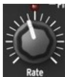
レート“Rate”ノブを使って、LFO のレートを設定します。設定可能なレンジは、遅いレート (0.1 Hz) から早いレート (100 Hz) まで。ノブを上にある赤い LED はレートのタイミングに合わせて点滅します。Clock スイッチが **Arpeg** に設定されていると、LFO レートよりもアルペジエーターのテンポクロックが優先されます（下記参照）。
