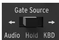
ゲートソース “Gate Source” スイッチを使って、どちらのゲート信号が MiniBrute のエンベロープをコントロールするか設定します。デフォルトの **KBD** 設定では、キーボードからゲート信号をトリガーします。**Hold** モードでは、他のゲート信号とは関係なく、エンベロープステージを SUSTAIN ステージに強制的に保ちます。このモードはドロー
