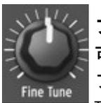
ファインチューン “**Fine Tune**” ノブを使えば、オシレーターピッチの詳細設定を行うことが可能です。12 時位置では、デフォルトチューニング (A 音=440 Hz Octave [4.2.8.3] デフォルト設定でキーボード右端から 2 つめの A 音) が選択された状態になっています。Fine Tune ノブのフルレンジは、-2 セミトーン ~ +2 セミトーンになります。ファインチューン機能を使うと、他の楽器を併用する場合はチューニングが狂っているように聞こえる場合があります。
