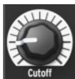
このノブを使ってカットオフ周波数を設定します。設定可能な周波数レンジは、反時計回りに振り切った状態（最小値）で 20 Hz、時計回り方向に振り切った最大値では 18 kHz に設定できます。例えば、LP モードでは、サウンドのブライトネス（明るさ）の度合いを調整できます。スライダを “0” 位置（最低値）に設定し、NOISE ジェネレータースライダを中間位置に、さらに filter envelope [4.2.2.7] と amplifier envelope [4.2.3.1] スライダを “0” 位置に設定します。さらに amplifier envelope の SUSTAIN スライダを最大値に設定します。フィルターモードは LP にセットし、ENV Amt [4.2.2.4] ノブを回して 12 時位置に、KBD Tracking ノブ [4.2.2.5] を Off に設定します。
