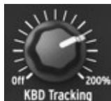
フィルターカットオフ周波数はキーボードからコントロールすることができます。KBD Tracking ノブを使うと、カットオフ周波数がキーボードに連携します。前述のカットオフの項目における例を使って説明しましょう。KBD Tracking ノブを“100%”（12時の位置）に設定し、キーボードのキーを幾つか叩いてみてください。演奏されるキーボードキーの高い音階に対応して、高いフィルターカットオフ周波数が設定されていることが理解できるでしょう。
