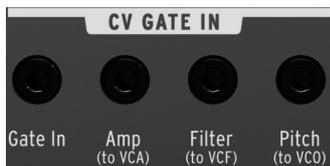
MiniBrute は、CV/GATE IN インターフェイスを介して、他のアナログデバイス（アナログシンセサイザー、ステップシーケンサーなど）と接続できます。CV とは Control Voltage の略です。CV/GATE 1/8" ジャックを使うと、他の外部アナログデバイスから MiniBrute のエンベロープをトリガーできます。主要な MiniBrute の機能（アンプボリューム、フィルターカットオフ周波数、オシレーターピッチ）を、それぞれ Amp (to VCA)、Filter (to VCF)、Pitch (to VCO) 1/8" ジャックからコントロールできます。
