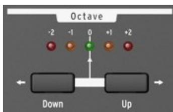
オクターブ “Octave” セクションから、MiniBrute のキーボードのピッチレンジをトランスポーズできます。5色の LED (-2 赤, -1 オレンジ, 0 緑, +1 オレンジ, +2 赤) のうち、1色が点灯して、現在選択されているオクターブレンジを示します。デフォルトは、“0” 位置（緑色の LED）で、キーボード左端の C キーは **C2** (130.81 Hz)、右端の C キーは **C4** (523.25 Hz) に対応します。例えば、デフォルトの状態から **Down** ボタンを1度
