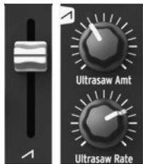
一般的なソウ（ノコギリ波）とウルトラソウの信号レベルは、スライダコントロールを使って設定できます。スライダコントロールは、ソウアイコンで表示されています。スライダを下方向いっぱい下げると、信号を完全にミュートします。反対にスライダを上げていくとレベルが上昇します。Ultrasaw Amt ノブを反時計回り方向に振り切ると、ソウ信号（ノコギリ波）のみ聞こえるようになります。ノブを時計回り方向に振り切ると、単純なソウ信号とミックスされ、ウルトラソウサウンドに近づきます。
