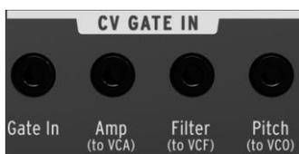
Le MiniBrute peut également se connecter à d'autres dispositifs analogiques (synthétiseur analogique, séquenceur pas à pas analogique, etc.) à travers l'interface **CV/GATE** où **CV** veut dire *Control Voltage* (tension de contrôle). La prise 3,5mm **Gate In** permet à d'autres appareils analogiques de déclencher les enveloppes du MiniBrute.
