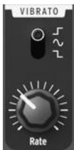
Le vibrato est un oscillateur basse-fréquence dédié à la modulation de *pitch* de l'oscillateur. Il est totalement indépendant des autres sources de modulation, et son amplitude et son déclenchement sont contrôlables respectivement par la molette de **Modulation** [3.2.4.1] et le sélecteur d'**Aftertouch** [3.2.4.2]. Il fournit plusieurs formes d'ondes de modulation disponibles grâce à un sélecteur trois-positions :
