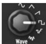
Le LFO offre plusieurs formes d'ondes de modulations, accessibles grâce au sélecteur rotatif **Wave** : sinus, triangle, dent-de-scie, carré, aléatoire par paliers (*Sample & Hold*), et aléatoire lissé.
