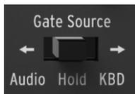
Le commutateur **Gate Source** sélectionne quel signal de déclenchement agit sur les enveloppes du MiniBrute.
