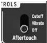
Le sélecteur d'**Aftertouch** définit l'assignation du signal d'*aftertouch*, très utile pour déclencher des modulations tout en jouant sur les touches et sans utiliser de potentiomètre ou de *slider*, permettant ainsi une plus grande expressivité. Ce sélecteur possède trois positions : l'*aftertouch* peut ainsi être routé vers la fréquence de coupure du filtre (**Cutoff**), être utilisé pour déclencher le **Vibrato** [3.2.5], ou être désactivé (**Off**).
