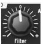
Le potentiomètre rotatif **Filter** contrôle l'amplitude et la polarité du signal de LFO envoyé au filtre, modulant ainsi la fréquence de coupure de celui-ci.
