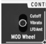
Le sélecteur **MOD Wheel** définit l'assignation de la molette de **Modulation** [3.2.8.2]. Selon la position du sélecteur, la molette de modulation contrôlera soit la fréquence de coupure du filtre (**Cutoff**), soit la quantité de vibrato appliquée à l'oscillateur (**Vibrato**), soit la quantité de LFO (**LFO Amt**) envoyée à ses différentes destinations (en l'occurrence : **PWM & Metalizer, Pitch, Filter** et **Amp**).
