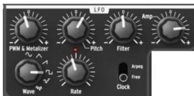
Le LFO est un oscillateur basse-fréquence. C'est la principale source de modulation vers les différentes sections du synthétiseur MiniBrute.
