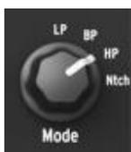
Le sélecteur rotatif **Mode** permet de choisir un mode parmi les quatre qu'offre le filtre : **LP** (*low-pass*, passe-bas), **BP** (*band-pass*, passe-bande), **HP** (*high-pass*, passe-haut), et **Notch** (réjecteur-bande).
