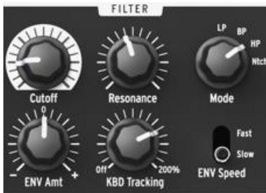
Le filtre modifie le timbre des signaux générés par l'oscillateur selon les quatre modes décrits précédemment (LP, BP, HP & Notch) [3.1.3.2]. Sa fréquence de coupure et sa résonance peuvent être réglés manuellement. La fréquence de coupure peut également être contrôlée par le clavier et par plusieurs modulateurs.
