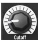
Le potentiomètre **Cutoff** règle la fréquence de coupure du filtre, de moins de 20Hz en position minimale jusqu'à 18kHz en position maximale.
