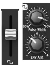
Lorsque le potentiomètre de niveau d'enveloppe **ENV Amt** est centré (au marquage 0) et que le potentiomètre **Pulse Width** est au minimum (au marquage 50%), on entend une onde carrée. En tournant le potentiomètre **Pulse Width** dans le sens horaire, on change le rapport cyclique du signal, transformant progressivement le carré en une pulsation jusqu'à un rapport cyclique de 90%, obtenant ainsi un son plus « acide » (proche d'un hautbois).
