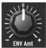
Le potentiomètre rotatif **ENV Amt** permet de contrôler l'amplitude et la polarité du signal d'enveloppe appliqué à la fréquence de coupure du filtre.
