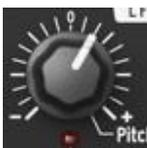
Le potentiomètre rotatif **Pitch** contrôle l'amplitude et la polarité du signal de LFO envoyé à l'oscillateur, modulant ainsi la fréquence de celui-ci.
