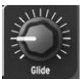
Le potentiomètre **Glide** règle la quantité de *portamento*, c'est à dire la durée de transition d'une note à une autre, lorsque celles-ci sont jouées au clavier ou via l'arpégiateur.
