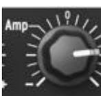
Le potentiomètre rotatif **Amp** contrôle l'amplitude et la polarité du signal de LFO envoyé à l'amplificateur, modulant ainsi le volume de celui-ci.
