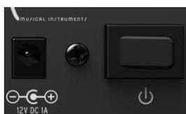
La fiche d'alimentation électrique reçoit la prise d'alimentation externe du MiniBrute. Ne connectez qu'un bloc d'alimentation correspondant aux spécifications suivantes : 12V DC, 1A, centre positif.
