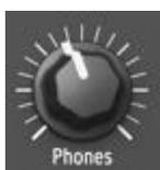
Le potentiomètre **Phones** contrôle le volume de sortie casque située sur le panneau arrière [3.3.3]. N'oubliez pas d'être prudent avec les niveaux sonores lors de l'écoute au casque.
