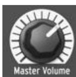
Le potentiomètre **Master Volume** définit le volume général de sortie du MiniBrute, lequel est au niveau ligne standard +4dBu. Pour couper le son du MiniBrute, tournez le potentiomètre au minimum dans le sens antihoraire.
