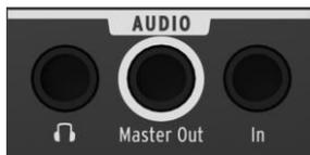
En utilisant un câble audio asymétrique, connectez la sortie **Master Out** à une table de mixage audio, à une carte son d'ordinateur, ou directement à un amplificateur audio. Le potentiomètre **Master Volume** [3.2.8.6] contrôle le volume de sortie.
