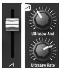
Le volume des signaux Dent-de-scie (*sawtooth*) et Ultrasaw est réglé par le potentiomètre rectiligne à l'icône en dent-de-scie. La position basse coupe le signal, en poussant vers le haut on augmente le volume du signal.
