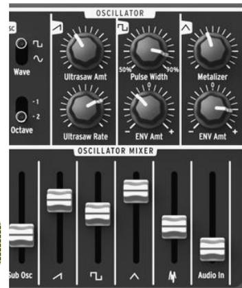
L'oscillateur délivre trois formes d'ondes de base : la dent-de-scie, la pulsation et le triangle. Ces formes d'ondes
