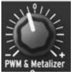
Le potentiomètre rotatif **PWM & Metalizer** contrôle l'amplitude et la polarité du signal de LFO envoyé à la fois la largeur d'impulsion du signal carré (initialement réglée par le potentiomètre **Pulse Width**), et à la quantité de repliement appliquée au signal triangle (initialement réglé par le potentiomètre **Metalizer**).
