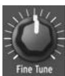
Le potentiomètre **Fine Tune** permet un réglage de précision du pitch de l'oscillateur. La position centrale correspond à la hauteur par défaut (c'est à dire La=440Hz) lorsque vous jouez le deuxième La le plus à droite du clavier lorsque l'**Octave** [3.2.8.3] par défaut est sélectionnée. La gamme complète du potentiomètre **Fine Tuning** est d'environ -2 demi-tons à +2 demi-tons. L'accordage fin permet d'accorder le MiniBrute à d'autres instruments qui sont légèrement désaccordés.
