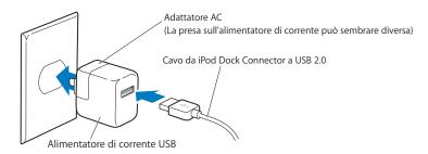
**ATTENZIONE:** assicurati che l'alimentatore di corrente sia completamente assemblato prima di collegarlo a una presa elettrica.
